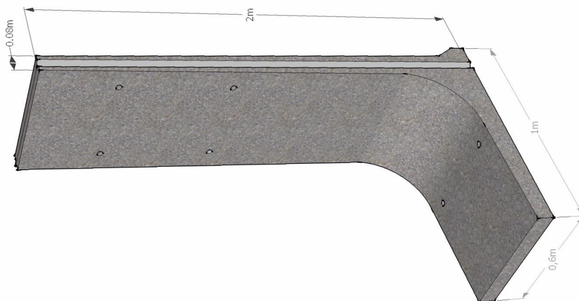
Afbeelding 47. Digitale reconstructie van een enkel profiel, zoals deze in het veld is opgemeten (afbeelding en bewerking: L. van Midden).
